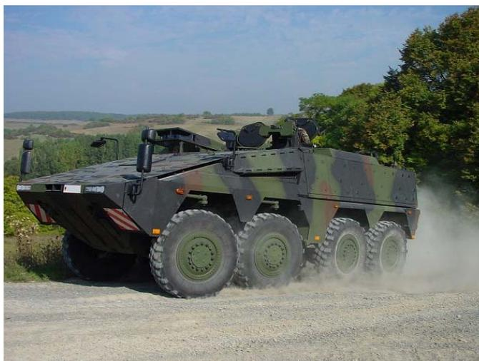
Dans sa version « transport de troupes », équipé d'une ventilation à filtre nucléaire, biologique et chimique, il pourra emporter sept combattants et sera doté d'une rampe de sortie arrière. Le toit a été conçu pour accueillir une tourelle avec épiscopes, mitrailleuse et lance grenades.
